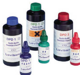
L : réactifs en liquide prédosé, en flacon compte-goutte
